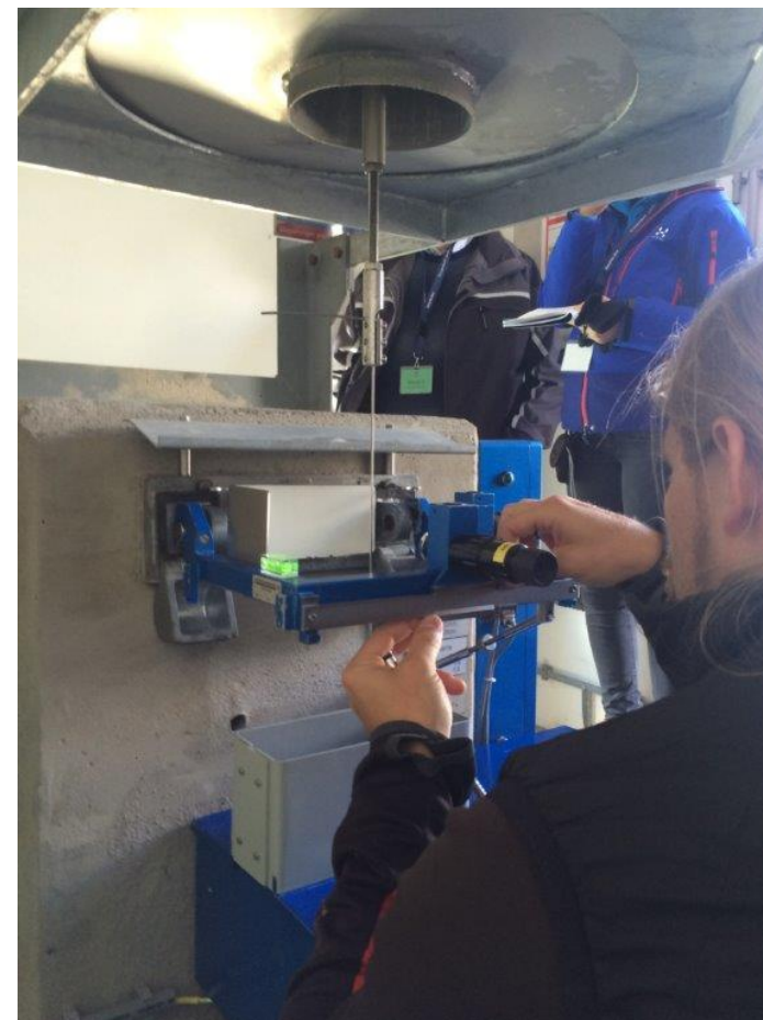
Kontroll av pendel mot fingerad förskjutning
